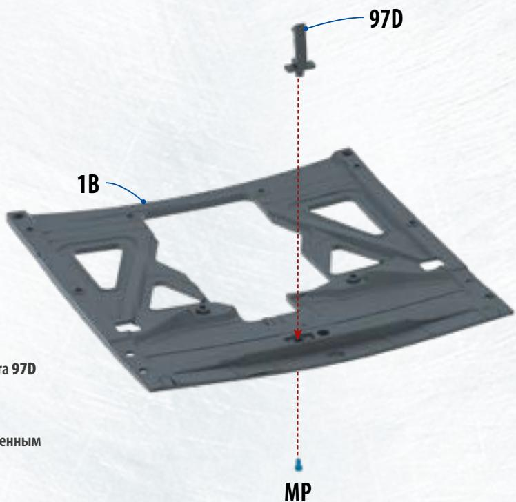
**98.2** **Вставьте основание** крючка капота 97D в предназначенное для него отверстие: оно расположено в центральной части передней стороны детали 1B. Зафиксируйте деталь 97D винтом MP, полученным вами с выпуском 97. ▶
